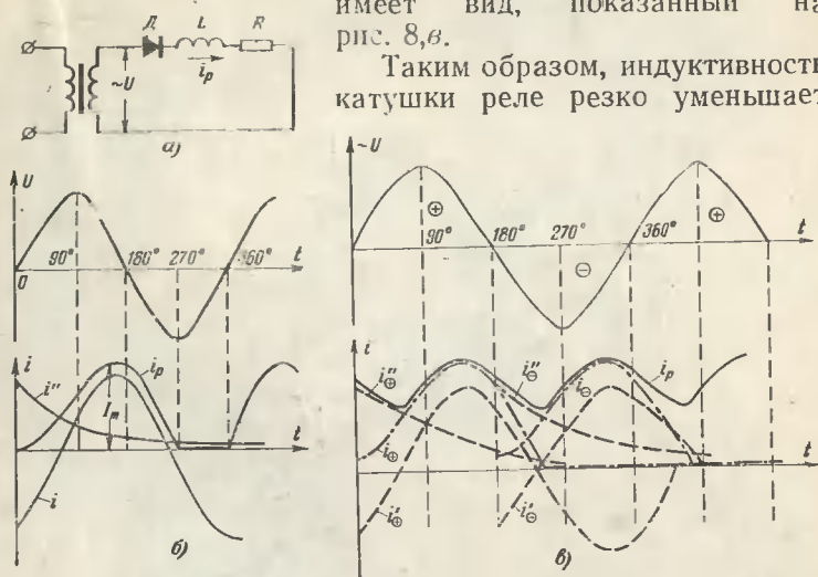
Рис. 8. Кривые изменения напряжения и токов в схемах напряжения с активно-индуктивной нагрузкой.
